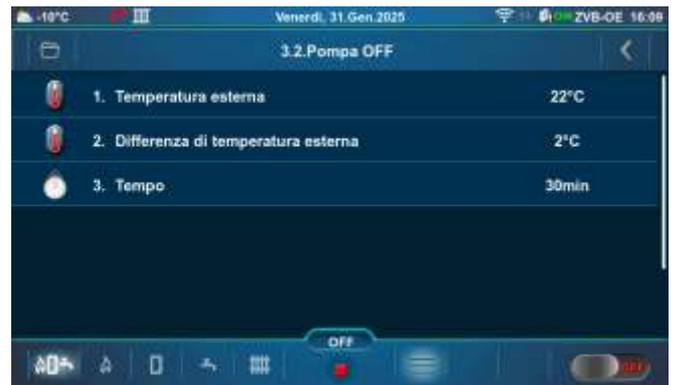
Configurazione: 1, 3, 8, 9, 12, 15, 20, 23 - se la temperatura esterna misurata è superiore alla temperatura esterna impostata + differenza di temperatura esterna impostata per la durata del tempo impostato, la pompa del circuito di riscaldamento viene spenta.
