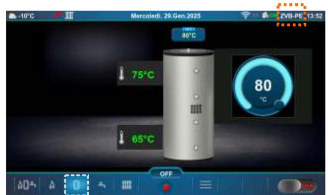
Schermata del serbatoio di accumulo (ZVB-PE)
