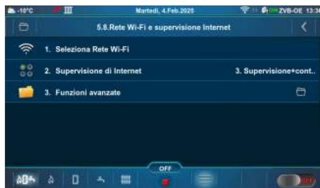
Quando il centralina è connesso alla caldaia e "Supervisione internet" è abilitato, una nuova icona appare sulla barra superiore dello schermo che indica lo stato della supervisione Internet.
