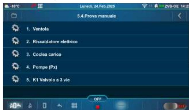
**IL PROVA MANUALE E POSSIBILE SOLO QUANDO LA CALDAIA NON E IN FUNZIONE!**
