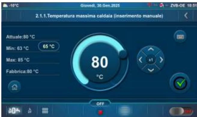
\*\*Esempio di impostazione della temperatura massima della caldaia: Configurazione 18.
